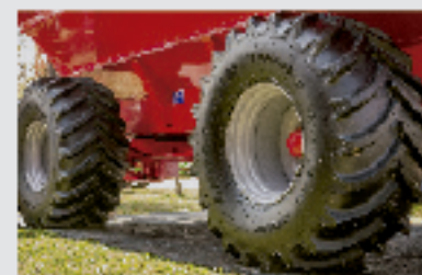
NEUMÁTICOS DE ALTA FLOTACIÓN ASEGURAN MÍNIMA COMPACTACIÓN DEL SUELO
