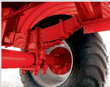
ROBUSTO TREN RODANTE CON ELÁSTICOS SEMIELÍPTICOS.
